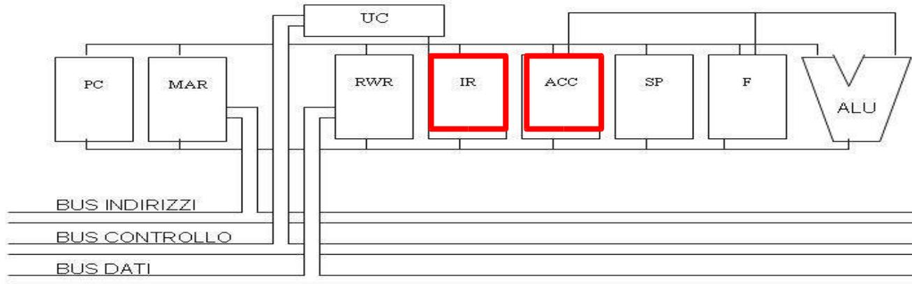
**IR** (instruction register) è il registro di istruzione, la sua funzione è di conservare il codice operativo dell'istruzione in corso di esecuzione.
