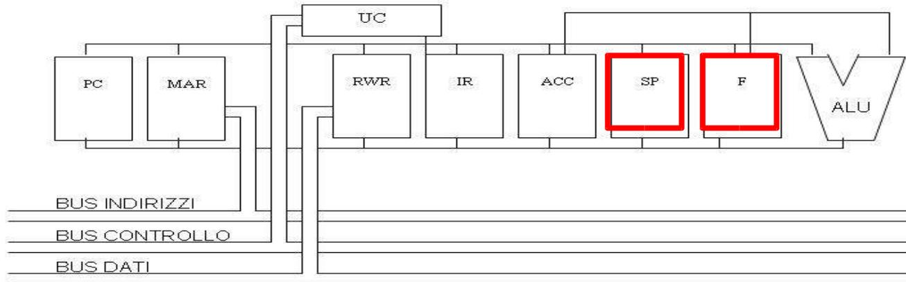
**SP** (stack pointer) è il puntatore all'area di stack, questo registro contiene l'indirizzo dell'ultima locazione occupata dall'area di stack o pila.
