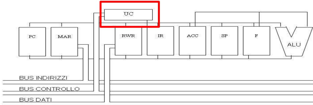
L'unità di controllo **UC** è il referente unico del bus di controllo; in base, infatti, ai segnali di controllo eventualmente attivati, o alle istruzioni date da programma, l'unità di controllo deve prendere le sue decisioni e attivare le parti coinvolte del processore, con l'unità di controllo che dunque si preoccupa di identificare e decodificare l'istruzione e di conseguenza eseguire l'azione relativa.
