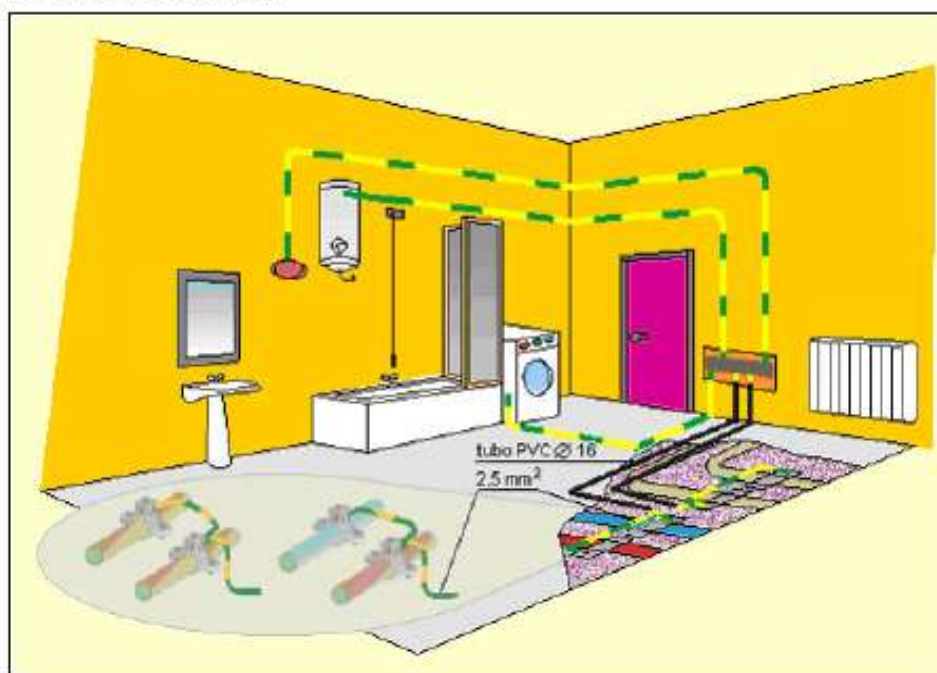
Fig. 7-Collegamenti equipotenziali
