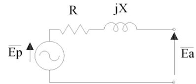
Queste considerazioni ci consentono di operare con il sistema monofase equivalente semplificando il problema. Nello schema di figura,  $E_p$  rappresenta la tensione a vuoto ed  $E_a$  quella a carico. **La resistenza e la reattanza non sono quelle di linea, ma dipendono dai parametri degli elementi della rete** (generatori, trasformatori, linea).
