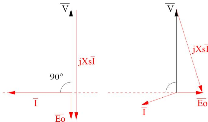
differenza di tensione ai capi della reattanza sincrona si massimizza proprio con i due vettori delle tensioni in fase e opposti. Non è garantito il raggiungimento di questa situazione, poiché l'alternatore potrebbe non reggere, dal punto di vista meccanico, il numero di giri elevatissimo a cui sarebbe sottoposto. In questo caso, l'angolo  $\delta$  vale  $180^\circ$  e di conseguenza la potenza erogata è nulla.
