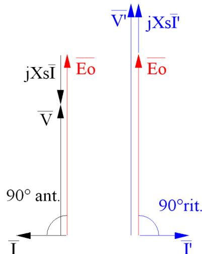
Con la corrente  $I$  in anticipo di  $90^\circ$  sulla tensione  $V$ . All'aumentare della tensione ( $V'$ ), la corrente diminuisce fino ad annullarsi (eventualmente) per poi cambiare di "verso" e diventa induttiva. La corrente di tipo induttivo ha in sostanza due conseguenze rilevanti:
