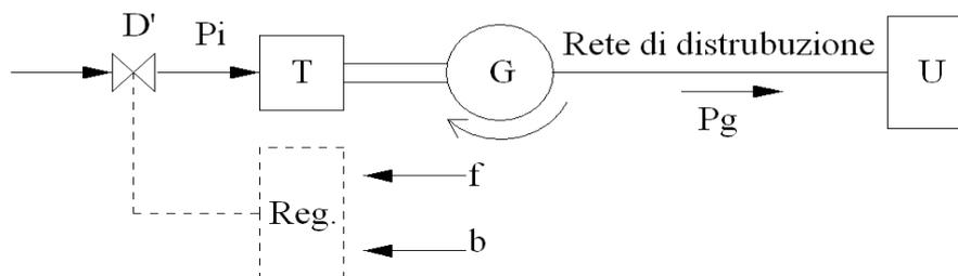
Il flusso dell'acqua che entra nella turbina  $T$  è regolato dal distributore  $D'$ , che variando la portata d'acqua  $Q$  (in funzione dei parametri  $b$ , dipendente dalla posizione del punto  $B$  sullo schema successivo, e  $f$ , con  $f \propto \Omega$ ) regola la potenza immessa  $P_i$  secondo la legge
