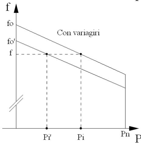
Disponendo di una macchina con variagiri, volendo ridurre la potenza immessa in turbina e quindi l'apertura del distributore, basterà agire sui variagiri per passare dalla potenza  $P_i$  alla potenza  $P_i'$  mantenendo costante la frequenza  $f$ .
