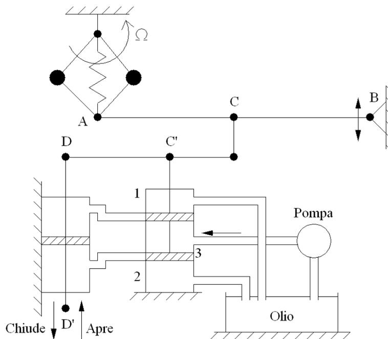
Al variare della velocità  $\Omega$  del generatore le due masse rotanti saranno soggette ad una diversa forza centrifuga che ne causerà l'allontanamento (aumento di velocità) o l'avvicinamento (diminuzione di velocità) dal loro asse di rotazione. Il punto A sarà soggetto a variazioni di altezza che si manifesteranno, data l'incernieratura nel punto B, sui punti C, C' e D. Gli effetti sono facilmente intuibili:
