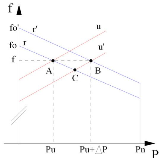
Analogamente a quanto visto per una singola macchina rotante, il punto di equilibrio si sposta, a seguito di un aumento della potenza richiesta, dal punto A al punto C, dopo un breve transitorio in B. Il gruppo rotante fittizio presenta però il vantaggio della ripartizione del carico sulle varie macchine, a condizione di mantenere costante la potenza complessiva erogata ottenendo una situazione è più elastica e più facilmente gestibile.
