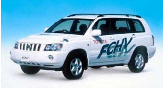
Toyota FCHV-3 (marzo 2001) Potenza: 90 kW Combustibile: idrogeno Autonomia: 300 km Velocità max: 150 km/h
