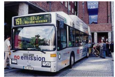
NEBUS Potenza: 250 kW (10 stack) Autonomia: 250 km Velocità max: 80 km/h
