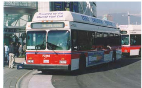
Flotta CMBC (Vancouver, Canada) Programma dimostrativo 1998-2000: oltre 6.000 ore di esercizio, 80.000 km percorsi, trasportati oltre 110.000 passeggeri
