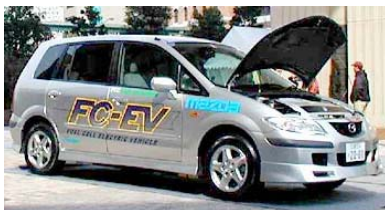
Mazda Premacy FC-EV Potenza totale: 65 kW Alimentazione: metanolo
