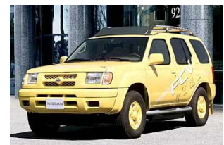
Nissan XTERRA Potenza cella: 75 kW Autonomi: 200 km
