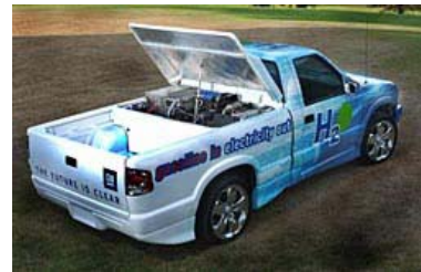
FC pick-up S-10 Potenza celle: 25 kW Alimentazione: benzina
