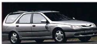
Renault FEVER (1998) Potenza celle: 30 kW Autonomia: 500 km Velocità max: 90 km/h
