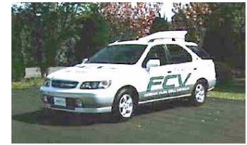
Nissan FCV Potenza cella: 10 kW
