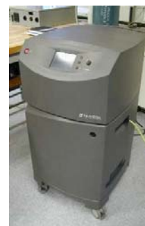
Unità da 1 kW a idrogeno
