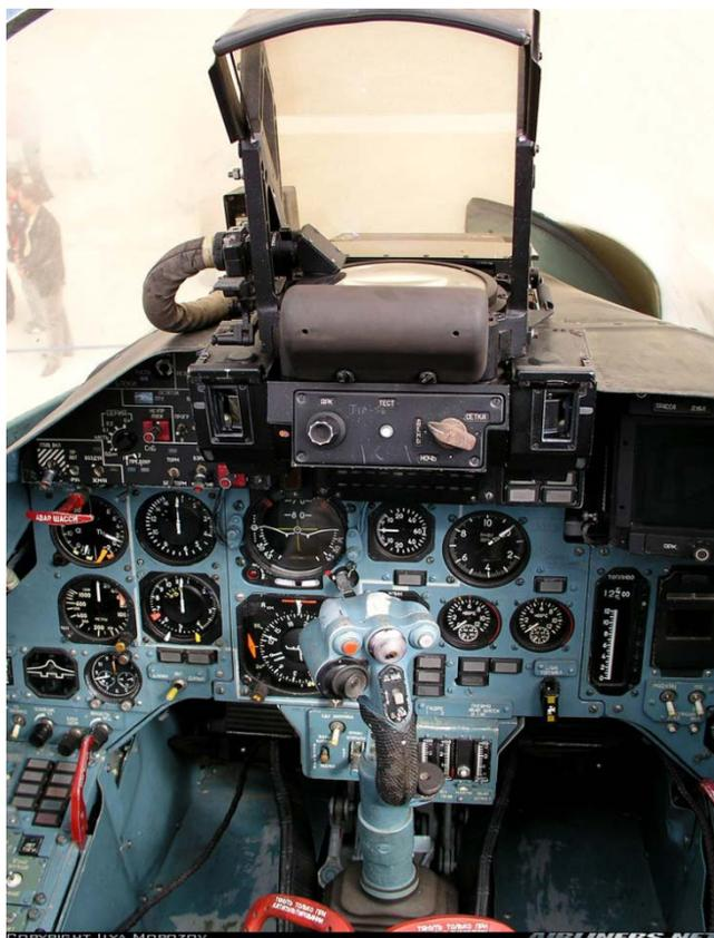
Un esempio dell'abitacolo di un Su-27S, si noti lo schermo HUD sul cruscotto integrato con la strumentazione di bordo.
