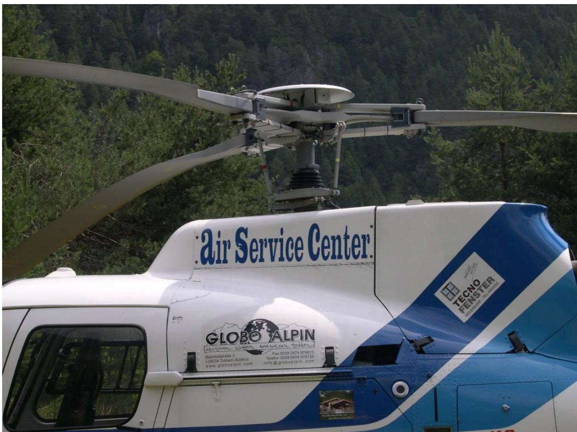
La caratteristica di tali materiali è l'elevata elasticità e la capacità di resistere a forti sollecitazioni; in pratica, le articolazioni di passo, flappeggio e ritardo non sono realizzate con cerniere meccaniche, ma il movimento è fornito dall'elasticità dei materiali costituenti il rotore. La foto sopra riporta il rotore principale, costruito interamente in materiali compositi, di un AS350 B3.
